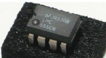
ICのピン番号は1ピンを示すマーク(このICの場合丸いくぼみ)を左下にする、時計とは逆回りで1~4~5~8となります。逆向きに取り付けてしまうと、動作しないばかりか、ICが壊れてしまいます。
