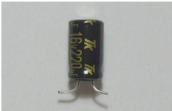
まず、基板の内側の220 $\mu$ Fをハンダ付けします。TA7368PGの側に+のリード線をハンダ付けします。
