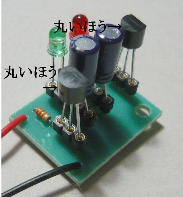
2つのトランジスタも挿し込みます。トランジスタの3本のリードには、それぞれエミッタ、コレクタ、ベースの区別があり、間違ってしまうと回路は動作しません。写真の様に、電池スナップのリード線側に丸い面が来るように、挿し込んでください。
