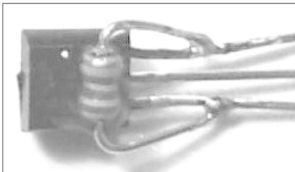
次に基板に部品をハンダ付けして行きます。抵抗 ジャンパ ダイオード ICソケット 積層セラミックコンデンサ 半固定抵抗 LED 電解コンデンサとハンダ付けを進めると作業しやすいと思います。
